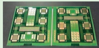
難燃性ソルダーレジストを使用したフレキシブル基板
