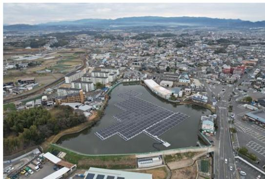
一般に太陽光パネルは温度が上昇すると発電量が減少する性質がありますが、水上設置型は水面の冷却効果により太陽光パネルの温度上昇を抑えることができるため、陸上設置型に比べて発電効率の点で有利といえます。また、水面への日射をさえぎることによるアオコ発生の抑制も期待できます。
