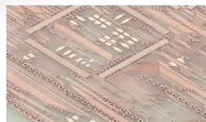
銅の回路パターンが露出しており、断線、ショートなど電氣的トラブルが起こる可能性がある。
